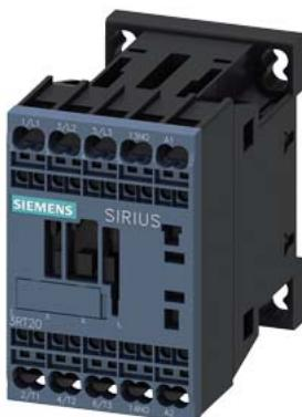
Силовой контактор, AC-3 7 A, 3 кВт/400 В 1 НО, 24 В AC, 50 / 60 Гц 3-полюсн., типоразмер S00, пружинная клемма
