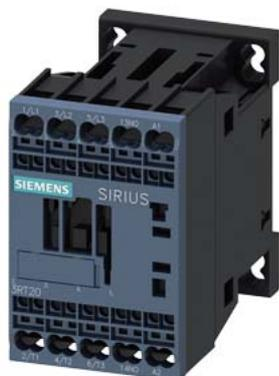
Силовой контактор, AC-3 7 А, 3 кВт/400 В 1 НО, 220 В AC, 50 / 60 Гц 3-полюсн., типоразмер S00, пружинная клемма
