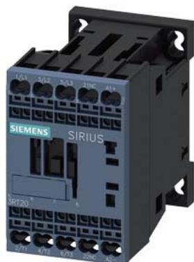
Силовой контактор, AC-3 7 A, 3 кВт/400 В 1 НЗ, 24 В DC 0,7–1,25\* US, 3-пол., типоразмер S00, пружинная клемма пригоден для выходов ПЛК без возможности установки вспомогательного выключателя
