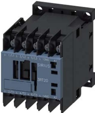
Силовой контактор, AC-3 7 А, 3 кВт/400 В 1 НО, 200 В AC, 50 Гц 200–220 В, 60 Гц, 3-полюс., типоразмер S00, присоединение глухого кабельного наконечника
