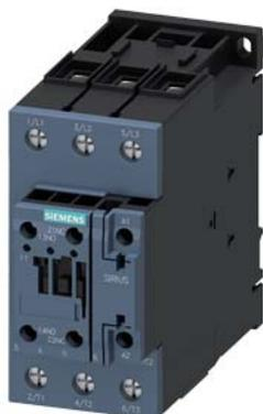
Силовой контактор, AC-3 80 A, 37 кВт/400 В 1 НО + 1 НЗ, 20–33 В AC/DC пригоден для обмена данными, с варистором, 3-полюсн., типоразмер S2 винтовой зажим
