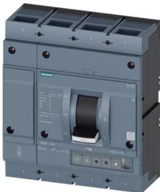
авт. выключатель 3VA2 IEC типоразмер 1000 класс коммутационной способности H Icu = 85 kA @ 415 В 4-пол., защита оборудования ETU330, LIG, In = 630 А защита от перегрузки Ir = 250...630 А защита от коротких замыканий li = 1,5...12 x In защита нейтрали регулируемая (ВЫКЛ., 50%, 100%) защита от замыканий на землю Ig = 0,2...1 x In = tg = 0,1/0,3 с плоский винтовой зажим
