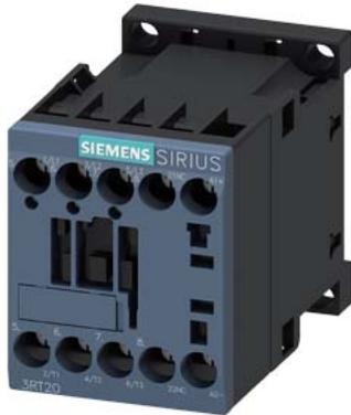
Силовой контактор, AC-3 7 A, 3 кВт/400 В 1 НЗ, 24 В DC пригоден для обмена данными, 3-полюсн., типоразмер S00, винтовой зажим
