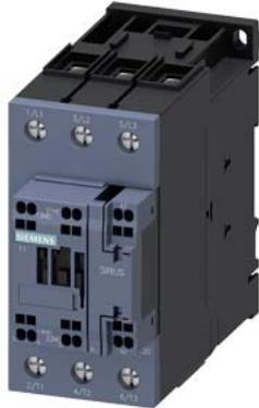
Силовой контактор, AC-3 80 A, 37 кВт/400 В 1 НО + 1 НЗ, 230 В AC 50/60 Гц, 3-полюсн. типоразмер S2, пружинная клемма вертикальное монтажное положение
