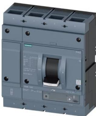
авт. выключатель 3VA2 IEC типоразмер 1000 класс коммутационной способности M Icu = 55 кА @ 415 В 4-пол., защита оборудования ETU340, ELISA LI, In = 800 А защита от перегрузки Ir = 320...800 А защита от коротких замыканий li = 10 x In защита нейтрали регулируемая (ВЫКЛ., 50%, 100%) плоский винтовой зажим
