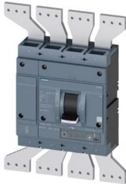
авт. выключатель 3VA2 IEC типоразмер 1250 класс коммутационной способности C Icu = 110 кА @ 415 В 4-пол., защита оборудования ETU340, ELISA LI, In = 1250 А защита от перегрузки Ir = 500...1250 А защита от коротких замыканий li = 10 x In защита нейтрали регулируемая (ВЫКЛ., 50%, 100%) плоский винтовой зажим
