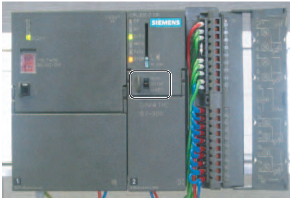
Bild 5-5 Erfolgreiche Verdrahtung, CPU in Stellung STOP
